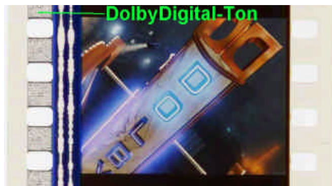
Abbildung 6 : Dolby Digital Ton zwischen Perforationslöchern
