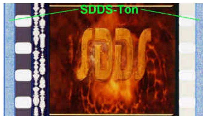
Abbildung 11 : SDDS Ton auf den Randspuren
